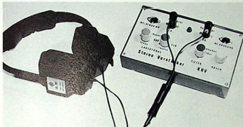
Bild 1. Stereo-Kopfhörerverstärker im pultförmigen Teko-Gehäuse mit angeschlossenen Stereo-Kopfhörern
